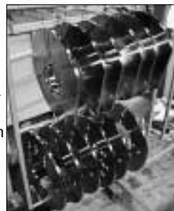
Figuur 9.2 Stroomloos vernikkelde stalen machinedelen
