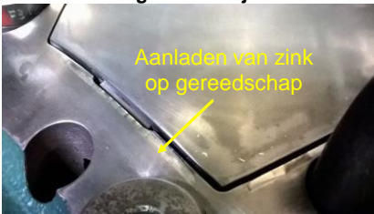
Afschilferen van Zinkdeeltjes bij trekrillen en scherpe afrondingen: afdrukjes in buitendelen
