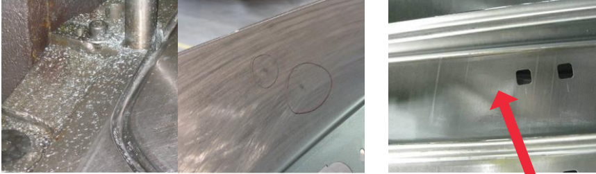
Afschilferen van Zinkdeeltjes bij trekrillen en scherpe afrondingen: afdrukjes in buitendelen
